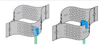
Figure 3 ATRA® Stake Edge Restraint
